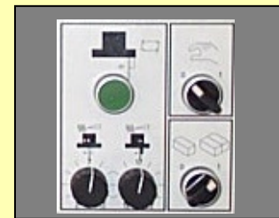
Avancement automatique de table avec différentes vitesses
