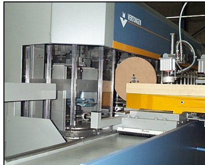
L'écran de sécurité bouche complètement la machine. Commande NC (99 pos)
