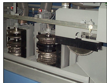
Plusieurs jeux d'outils peuvent être montés sur les arbres longs de 545.
